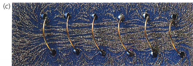
27.10 a) Magnetfeldlinien einer stromdurchflossenen Spule. b) Das Linienmuster gleicht dem eines Stabmagneten gleicher Gestalt. c) Magnetfeldlinien einer Spule, sichtbar gemacht mit Hilfe von Eisenfeilspänen.
