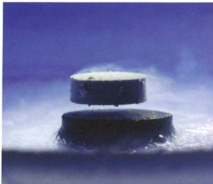
Das magnetische Schweben beruht auf der Abstoßung zwischen dem Magnetfeld des Permanentmagneten und dem Magnetfeld, das die im Supraleiter induzierten Ströme erzeugen.
