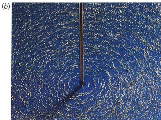
27.15 a) Zur Bestimmung der Richtung des von einem langen, geraden, stromdurchflossenen Leiter erzeugten Magnetfelds wenden wir die Rechte-Hand-Regel an. Die Magnetfeldlinien bilden Kreise um den Draht in Richtung der Finger der rechten Hand, wenn der Daumen in die Stromrichtung zeigt. b) Feldlinien des von einem langen Draht hervorgerufenen Magnetfelds, sichtbar gemacht durch Eisenfeilspäne.
