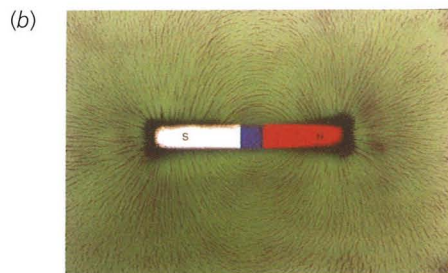
26.8 a) Magnetfeldlinien innerhalb und außerhalb eines Stabmagneten. Die Linien treten am Nordpol aus dem Magneten aus und am Südpol wieder ein. Sie haben aber weder Anfangs- noch Endpunkt, sondern bilden geschlossene Schleifen. b) Magnetfeldlinien in der Umgebung eines Stabmagneten, sichtbar gemacht mit Hilfe von Eisenfeilspänen.
