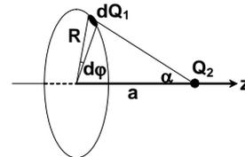
$dF = \frac{1}{4\pi\varepsilon_0} \frac{Q_1 Q_2}{R^2 + a^2} \frac{d\varphi}{2\pi}$  mit  $R = \frac{l}{2\pi}$ . Die Komponente in z-Richtung ist gegeben durch
