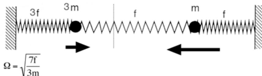
da im Vergleich zu Aufgabe 1 die Summe der Massen schwerer ist ( $4m$  vs.  $2m$ ), die Rückstellkonstante der Kopplungsfeder aber gleich geblieben ist ( $f$ ), ergibt sich eine „schwächere“ Kopplung, was zu einer geringeren Aufspaltung der beiden Eigenfrequenzen führen sollte. In der Tat:  $\sqrt{\frac{f}{m}} < \sqrt{\frac{7f}{3m}} < \sqrt{\frac{3f}{m}}$ .  $\rightarrow$  o.k.
