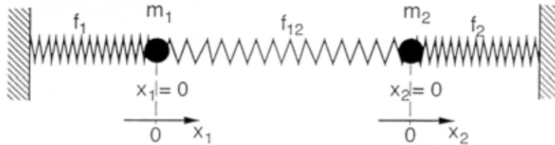
Gegeben sei obiges gekoppeltes Federpendel mit den Massen  $m_1$  und  $m_2$ , die durch Federn mit den Rückstellkonstanten  $f_1$  bzw.  $f_2$  an fixe Aufhängungspunkte (Wand) gebunden sind, sowie durch eine Feder mit Rückstellkonstante  $f_{12}$  gekoppelt sind. Im Ruhezustand befindet sich  $m_1$  am Ort  $x_1 = 0$  und  $m_2$  am Ort  $x_2 = 0$ .
