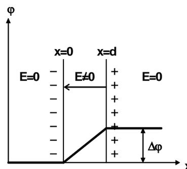
Wählt man beispielsweise als geschlossene Fläche einen Würfel mit Kantenlänge  $a$ , sodass die Ebene  $x = 0$  den Würfel in zwei gleiche Hälften teilt, ergibt nur eine Seitenfläche einen Beitrag zu  $\oint \vec{E} d\vec{A} = -E a^2$ . Die eingeschlossene Ladung ist dabei
