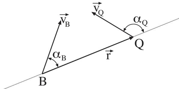
Ein Beobachter  $B$  bewegt sich mit einer Geschwindigkeit  $v_B$  in einem Winkel  $\alpha_B$  zur Verbindungslinie Beobachter  $B$  - Quelle  $Q$ . Die Quelle  $Q$  bewegt sich mit einer Geschwindigkeit  $v_Q$  in einem Winkel  $\alpha_Q$  zur Verbindungslinie  $B$ - $Q$ . Die Quelle emittiert (Kugel)wellen bei einer Frequenz  $f_Q$  welche sich mit der Phasengeschwindigkeit  $c$  im Raum ausbreiten.
