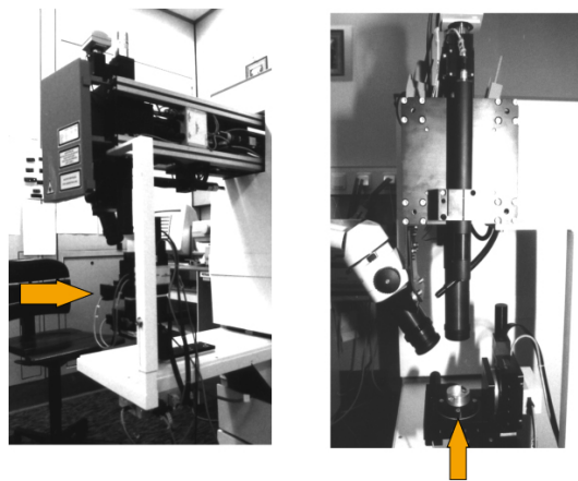
Abbildung 7.23: Prinzip und Anlage für die computergesteuerte Laser-Hornhautbearbeitung
