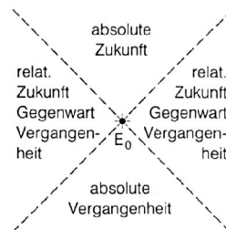
Fig. 12.13: Die von einem Raumzeitpunkt E_0 ausgehenden Lichtgeraden trennen die absolute Vergangenheit und die absolute Zukunft voneinander. Alle Beobachter, gleichgültig mit welchen Geschwindigkeiten sie sich bewegen, sind sich über die zeitliche Einordnung von Ereignissen in diesem Raumzeitgebiet relativ zu E_0 einig. Nicht so jedoch für Ereignisse in den Raumzeitbereichen rechts und links; je nach dem Bewegungszustand des Beobachters werden sie von diesem vor, gleichzeitig oder nach E_0 eingeordnet. Keines dieser Ereignisse kann Ursache oder Folge von E_0 sein, denn keines kann durch ein Signal mit E_0 verbunden werden.
