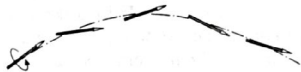
Fig. 10.19: Durch einen Drall um die Längsachse werden Speere auf ihrer Flugbahn stabilisiert.
