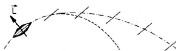
Fig. 10.17: Ein schwerer rotierender Diskus führt wegen seines großen Drehimpulses in Flug nur eine sehr geringfügige Präzessionsbewegung aus und behält fast über die ganze Flugbahn hinweg seine Schräglage bei. Unter Ausnutzung der Tragflächenwirkung fliegt er viel weiter als eine gleich schwere Kugel.
