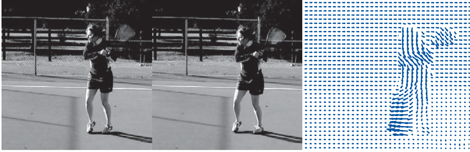
Abbildung 24.10: Zwei Frames einer Videosequenz. Auf der rechten Seite ist das Vektorfeld des optischen Flusses dargestellt, das der Verschiebung von einem Frame zum anderen entspricht. Die Bewegungen des Tennisschlägers und des vorderen Beines werden durch die Richtungen der Pfeile erfasst. (Mit freundlicher Genehmigung von Thomas Brox.)
