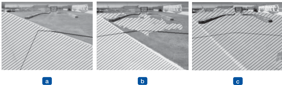
Abbildung 25.13: Ergebnisfolge eines Klassifizierers für „Befahrbare Oberfläche“ mithilfe einer adaptiven Vision. In (a) wird nur die Straße als befahrbar klassifiziert (gestreifter Bereich). Die V-förmige dunkle Linie zeigt die Richtung des Fahrzeuges an. In (b) wird das Fahrzeug angewiesen, die Straße zu verlassen und auf einer grasartigen Oberfläche zu fahren. Der Klassifizierer beginnt dann, einen Teil des Grasabschnittes als befahrbar zu klassifizieren. In (c) hat das Fahrzeug sein Modell der befahrbaren Oberfläche aktualisiert, um sowohl dem Gras als auch der Straße zu entsprechen.
