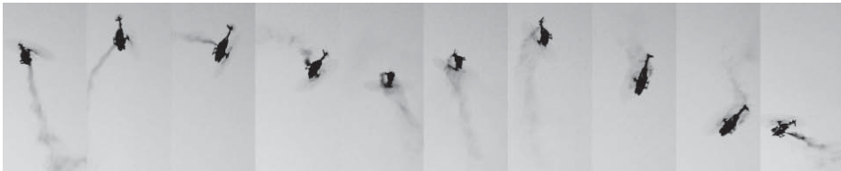
Abbildung 25.25: Mehrere Aufnahmen eines ferngesteuerten Hubschraubers, der einen Flip (Drehung um die Querachse oder Überschlag um die Nickachse) ausführt, und zwar basierend auf einer Strategie, die mit Reinforcement-Learning gelernt wurde. Bilder mit freundlicher Genehmigung von Andrew Ng, Universität Stanford.
