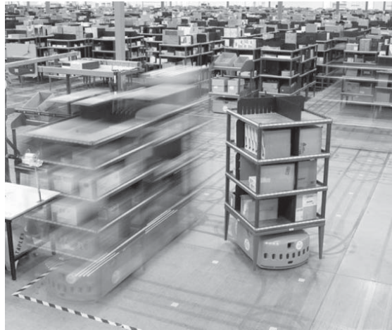
Abbildung 25.27: (a) Der Helpmate-Roboter transportiert Essen und andere medizinische Gerätschaften in Dutzenden von Krankenhäusern auf der ganzen Welt. (b) Kiva-Roboter sind Teil eines Materialzuführungssystems für bewegliche Regale in Versandzentren. Bild mit freundlicher Genehmigung von Kiva Systems.
