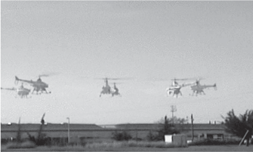
Abbildung 21.10: Übereinandergelegte Zeitrafferaufnahmen einer Autopilot-Helikoptervorführung mit einem sehr schwierigen „Nase im Kreis“-Manöver. Der Helikopter wird von einer vom PEGASUS-Strategiesuchalgorithmus entwickelten Strategie gesteuert. Es wurde ein Simulatormodell entwickelt, indem die Effekte der verschiedenen Steuerungsreaktionen bei einem realen Helikopter beobachtet wurden. Anschließend wurde der Algorithmus über Nacht auf dem Simulatormodell ausgeführt. Eine Vielzahl von Steuerungen für unterschiedliche Manöver wurden entwickelt. In allen Fällen übertraf die Leistung die von erfahrenen Piloten unter Verwendung von Fernsteuerung. (Bild mit freundlicher Genehmigung von Andrew Ng.)
