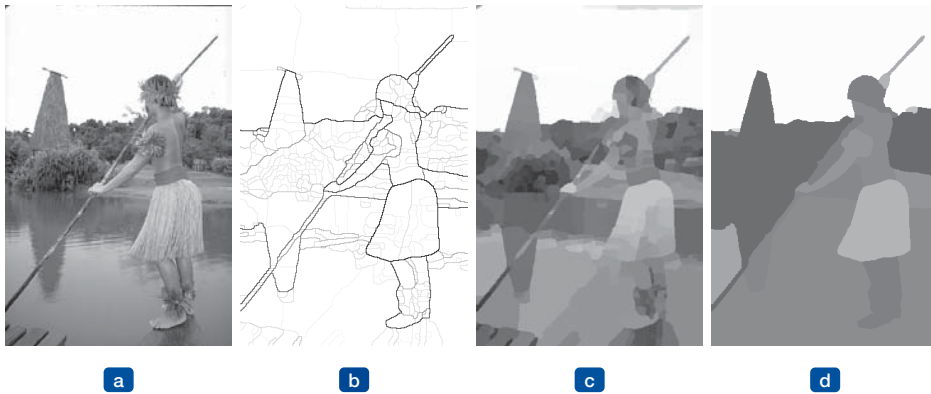
Abbildung 24.11: (a) Originalbild. (b) Grenzkonturen, wobei die Kontur umso dunkler ist, je höher der P_b -Wert liegt. (c) Segmentierung in Bereiche, die einem Detailabschnitt des Bildes entsprechen. Bereiche werden in ihren durchschnittlichen Farben wiedergegeben. (d) Segmentierung in Bereiche, die einem größeren Abschnitt des Bildes entsprechen, wodurch sich weniger Bereiche ergeben. (Mit freundlicher Genehmigung von Pablo Arbelaez, Michael Maire, Charles Fowlkes und Jitendra Malik).
