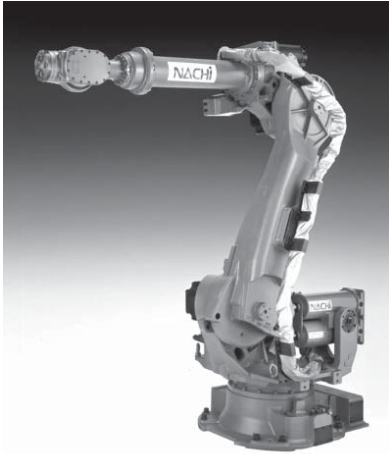
Abbildung 25.1: (a) Ein Industrieroboter als Manipulator für das Stapeln von Säcken auf Paletten. Bild mit freundlicher Genehmigung von Nachi Robotic Systems. (b) Die humanoiden Roboter P3 und Asimo von Honda.
