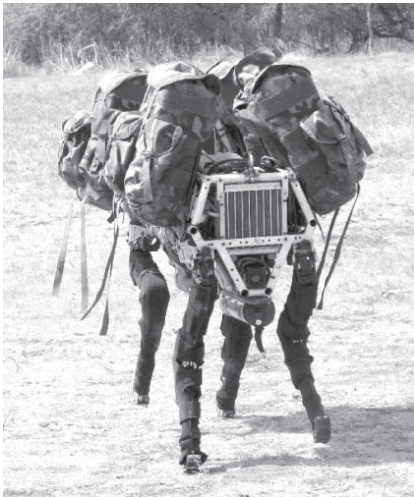
Abbildung 25.6: (a) Vierbeiniger, dynamisch stabiler Roboter „Big Dog“. Bild mit freundlicher Genehmigung von Boston Dynamics, © 2009. (b) RoboCup Standard Platform League-Weltmeisterschaft 2009 mit dem Gewinnerteam B-Human vom DFKI an der Universität Bremen. Das gesamte Spiel über war B-Human seinen Gegnern mit 64:1 überlegen. Der Erfolg ist zurückzuführen auf probabilistische Zustandsbewertung mithilfe von Partikel- und Kalman-Filtern, auf Modelle für maschinelles Lernen zur Gangoptimierung und auf dynamische Stoßbewegungen. Bild mit freundlicher Genehmigung des DFKI, © 2009.
