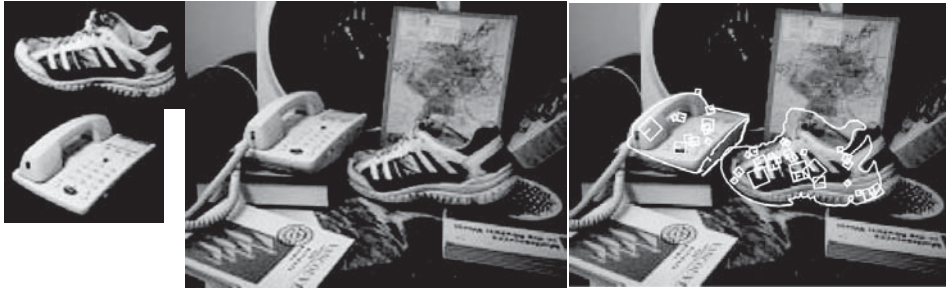
Abbildung 24.15: Ein weiteres Beispiel für Objekterkennung, das mit SIFT 3 arbeitet, einem Vorläufer von HOG. Auf der linken Seite dienen Bilder eines Schuhs und eines Telefons als Objektmodelle. In der Mitte ist ein Testbild zu sehen. Auf der rechten Seite wurden der Schuh und das Telefon erkannt. Dazu wurden Punkte im Bild gesucht, deren SIFT-Merkmalbeschreibungen mit einem Modell übereinstimmen. Anschließend wurde eine Schätzung der Modellpose berechnet und diese Schätzung verifiziert. Eine starke Übereinstimmung wird normalerweise mit seltenen falschen Positivwerten verifiziert. Bilder von Lowe (1999) © IEEE.
