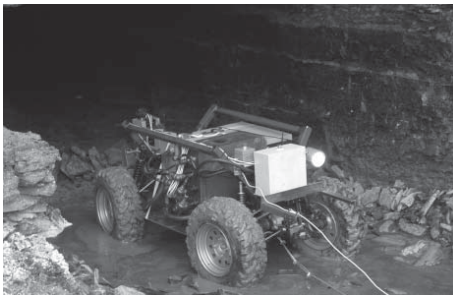
Abbildung 25.29: (a) Ein Roboter, der eine Karte von einer verlassenen Kohlenmine anfertigt. (b) 3D-Karte einer Mine, die der Roboter erstellt hat.
