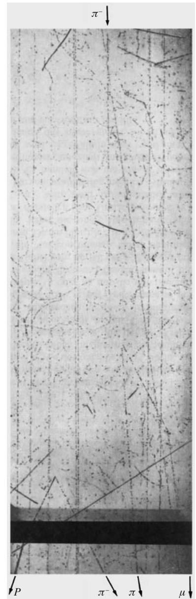
Abb. 18.39. Blasenkammer-Aufnahme: Ein 1,1 \text{ GeV-}\pi^- stößt auf ein Proton und erzeugt ein K_1^0 und ein \Lambda^0 . Das \Lambda^0 zerfällt links unten wieder in ein p und ein \pi^- , das K_1^0 rechts unten in zwei geladene Pionen; eines davon macht kurz darauf einen \pi \rightarrow \mu -Zerfall durch. (Nach Glaser, aus W. Finkelburg: Einführung in die Atomphysik , 11./12. Aufl. (Springer, Berlin Heidelberg 1976))
