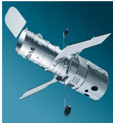
Abb. 9.50. Hubble Space Telescope mit geöffneter Klappe zum 2,4 m-Spiegel (ESA und Jan Erik Rasmussen, mit freundlicher Erlaubnis)
