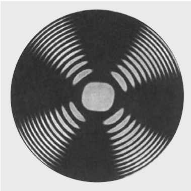
Abb. 10.71. Interferenzbild einer senkrecht zur optischen Achse geschnittenen Kalkspatplatte
