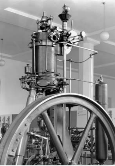
Rudolf Diesels (1858–1913) erster funktionierender Motor. Zwölf Jahre versuchte Diesel in Lindes Firma einen selbstzündenden Motor zu entwickeln, der Carnots Wirkungsgrad möglichst nahe käme. Sein 1892 patentiertes Modell lief nur eine Minute, erst 1897 lief ein industriell verwendbarer Zweizylinder-Viertakter mit 25 PS
