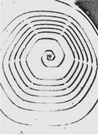
Abb. 17.81. Elektronenmikroskopische Aufnahme einer frisch gewachsenen Kristallfläche: Der Kristall hat die Schwierigkeit der Neubildung von Netzebenenkeimen durch Ausnutzung einer Schraubenversetzung überwunden (Spiralwachstum). (Nach Gahn, aus W. Finkelnburg: Einführung in die Atomphysik , 11./12. Aufl. (Springer, Berlin Heidelberg 1976))
