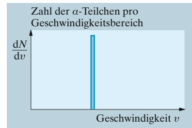
Abb. 18.16. Geschwindigkeitsspektrum von \alpha -Strahlung
