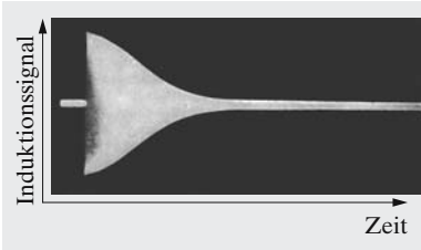
Abb. 14.52. Freier Induktionszerfall von Protonen in Wasser, Halbwertszeit ca. 10 ms. Der 90^\circ -Hf-Impuls von 10 \mu\text{s} Dauer, der das Signal „anstößt“, ist nicht gezeigt
