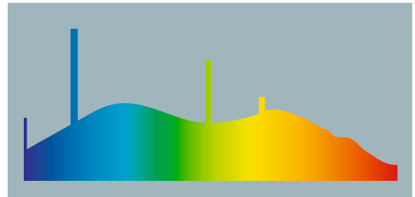
Abb. 11.27. Viel besser sind visueller Wirkungsgrad und Anpassung an das Spektrum des Tageslichts bei der Leuchtstoffröhre. Durch das kontinuierliche Lumineszenzspektrum des Leuchtstoffes auf der Rohrrinnenwand schimmern die diskreten Linien der Hg-Füllung durch
