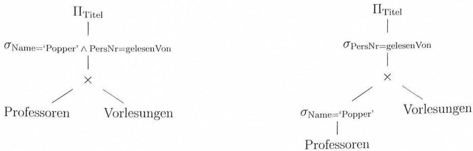
Abbildung 8.3: Baumdarstellung der algebraischen Ausdrücke
