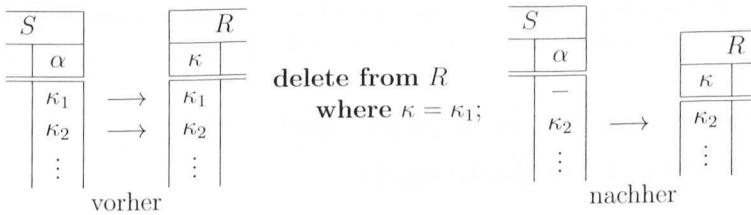
Abbildung 5.2: Referentielle Integrität durch Nullsetzen
