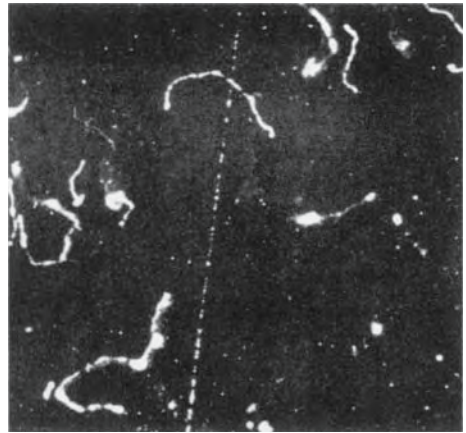
Abb. 8.12. Bahnen von \beta -Teilchen; die gerade, nicht geschlossene Nebelspur stammt von einem schnellen Teilchen, die verschlungenen von langsamen (Aufnahme: Rutherford; nach Westphal)
