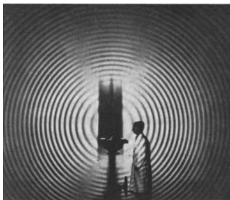
Abb. 7.66a,b. Spaltet man ein Lichtbündel in zwei Teilbündel auf, so bestehen beide aus der gleichen Folge von Wellengruppen und werden damit interferenzfähig (a), solange der Gangunterschied die Kohärenzlänge nicht überschreitet (b)
