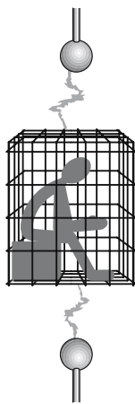
Abb. 6.50. Faraday-Käfig zum Abschirmen eines Menschen vom Feld einer Hochspannungsanlage
