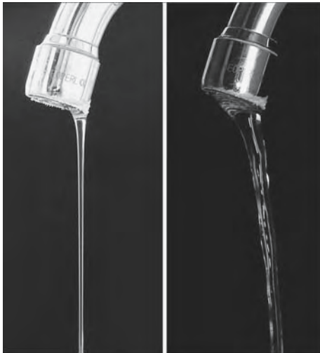
Abb. 3.30. Wasser aus dem Wasserhahn: bei fast zuge-drehtem Hahn ist die Strömung laminar (links); dreht man stärker auf, so wird sie turbulent (rechts)
