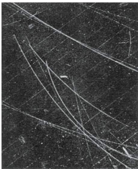
Abb. 8.14. Bahnen von Protonen in der Nebelkammer; sie sind gekrümmt, weil bei der Aufnahme ein Magnetfeld in Blickrichtung der Kamera bestand. Die Aufnahme diente dem Nachweis schneller Neutronen, die als neutrale Teilchen nicht ionisieren und darum keine Bahns Spuren hinterlassen. Bei hinreichend zentralem Stoß übertragen sie ihre kinetische Energie auf die in der Kammer in Form von Wasserstoffgas vorhandenen Protonen. (Aufnahme: Radiation Laboratory, University of California; nach Finkelnburg)
