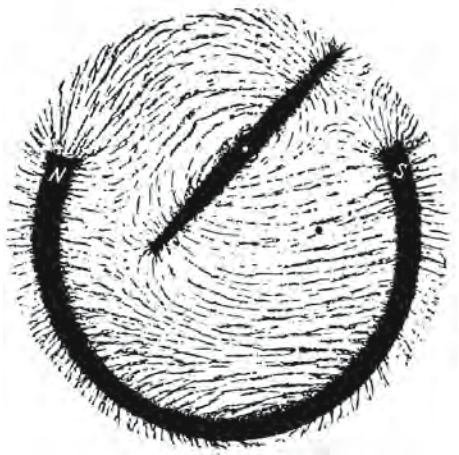
Abb. 6.72. Magnetische Feldlinien lassen sich mit Eisenfeilspänen sichtbar machen: Hufeisenmagnet ohne und mit Kompassnadel (nach R.W. Pohl)
