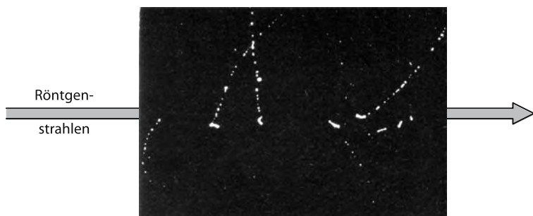
Abb. 8.13. Quanten hinterlassen keine eigenen Spuren in der Nebelkammer; die von ihnen ausgelösten Elektronen ziehen aber Spuren nach Art von \beta -Teilchen seitlich aus dem Quantenbündel heraus (nach R.W. Pohl)
