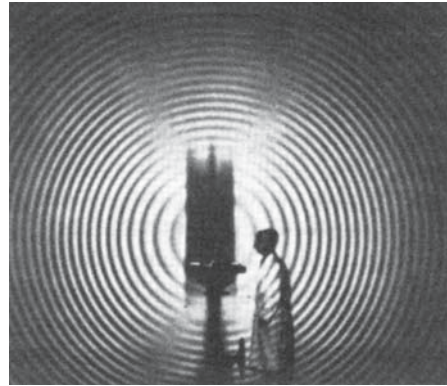
■ Abb. 7.74a,b. Interferenz durch Aufspaltung. Spaltet man ein Lichtbündel in zwei Teilbündel auf, so bestehen beide aus der gleichen Folge von Wellengruppen und werden damit interferenzfähig (a), solange der Gangunterschied die Kohärenzlänge nicht überschreitet (b)
