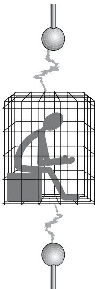
■ Abb. 6.52. Faraday-Käfig zum Abschirmen eines Menschen vom Feld einer Hochspannungsanlage
