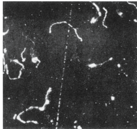
■ Abb. 8.15. Bahnen von \beta -Teilchen; die gerade, nicht geschlossene Nebelspur stammt von einem schnellen Teilchen, die verschlungenen von langsamen (Aufnahme: Rutherford; nach Westphal)
