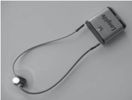
■ Abb. 6.2. Stromkreis. Batterie und Glühlampe als geschlossener Stromkreis
