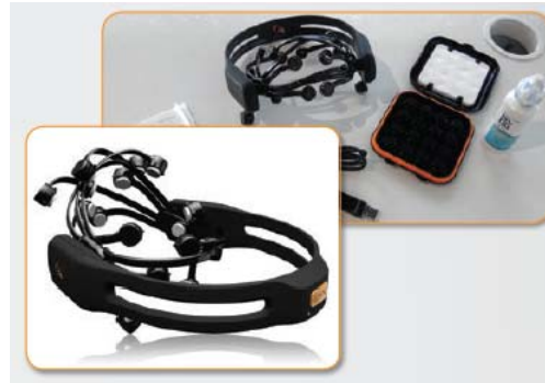
Sučelje za komunikaciju čovjeka s računalom korištenjem električnih aktivnosti mozga EPOC Emotiv Systems, San Francisco, California, USA
